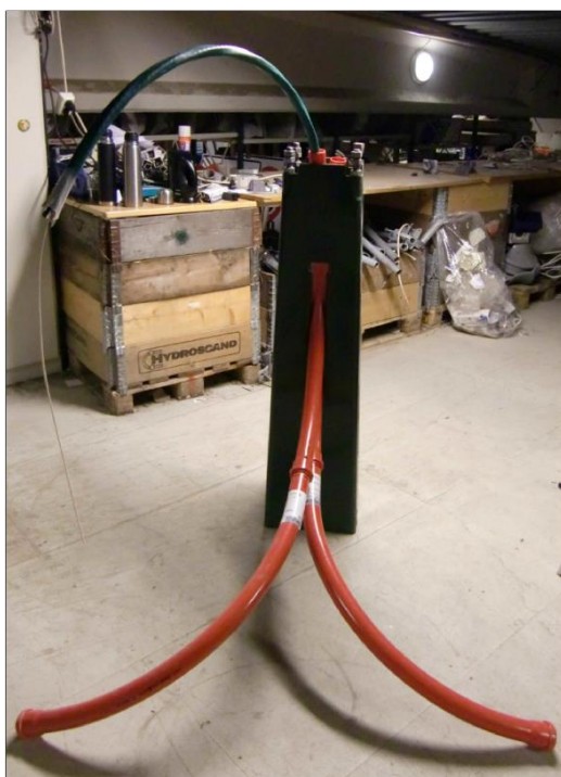
Figur 2: Eksempel på utførelse med fundament, trekkerør og bend.
